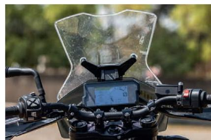
Sur la version S, la bulle plus haute est, elle aussi, réglable via une seule vis placée à l'avant.
