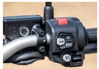
Simple, la commande du DCT permet de régler les temps de passage des rapports. Notez la position du régulateur de vitesse, de série sur ce modèle.
